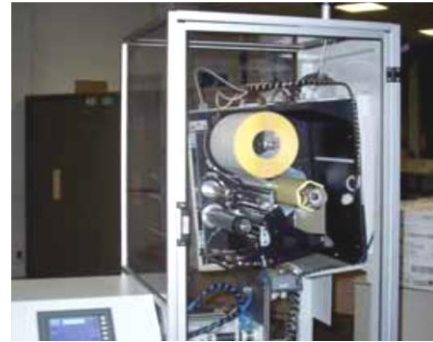
Particolare del gruppo di stampa delle etichette in formato A4. Particular of the printer for A4 labels.
