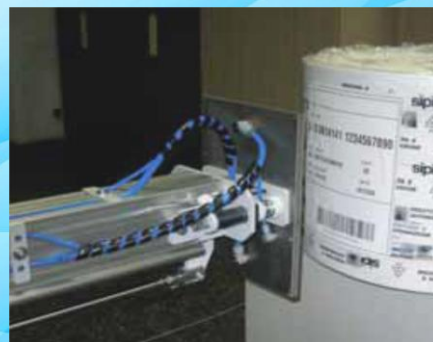
Particolare del sistema di applicazione "a soffio d'aria" per superfici curve. Particular of the "air-puff" application system for curved surfaces.
