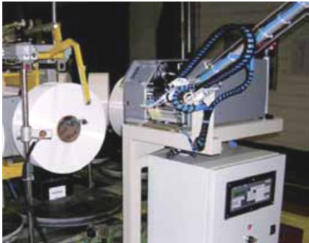
Sistema ETICONO per l'applicazione di etichette all'interno dell'anima di bobine, rocche ecc. "ETICONO" System for applying labels inside bobbins, reels etc.
