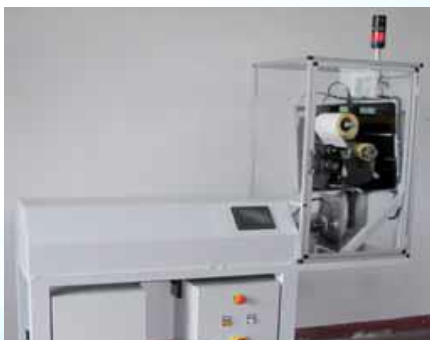
Etichettatore per etichette di dimensioni A4 con verifica del codice a barre applicato. Labelling system for A4 labels, with check of the barcode applied.
