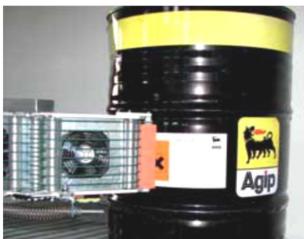
Etichettatore per l'applicazione automatica dell'etichetta su fusti o superfici curve. Labelling system for applying the label on drums or curved surfaces.
