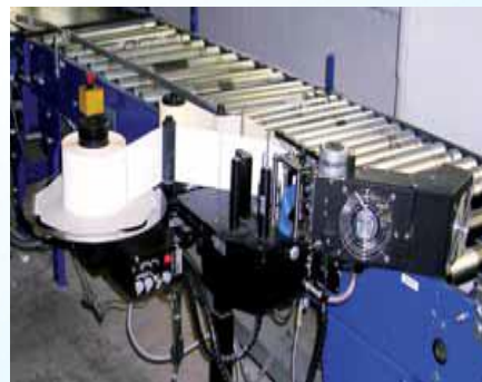
Etichettatore per l'applicazione automatica di una etichetta "ad angolo" sul fronte e lato del collo. Labelling system for applying a label on the front and on the side of the parcel.
