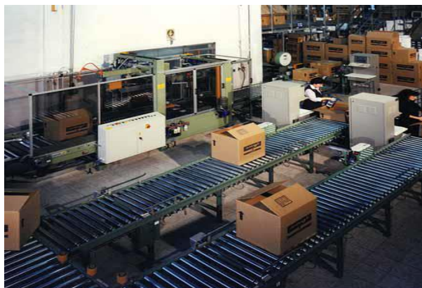
Linea di trasporto interno ed imballaggio di scatole con formatura automatica dei colli.
