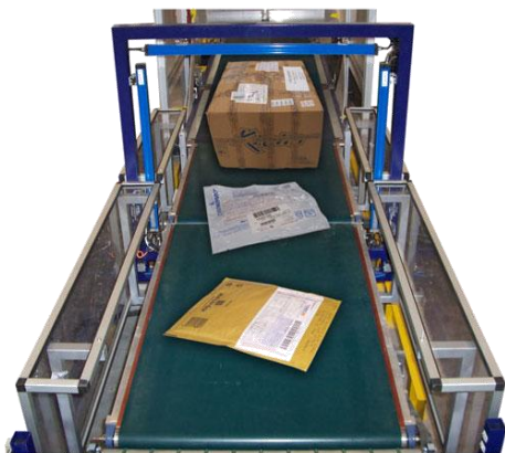
Linea per l'identificazione e la selezione automatica di plichi, buste e pacchi.
